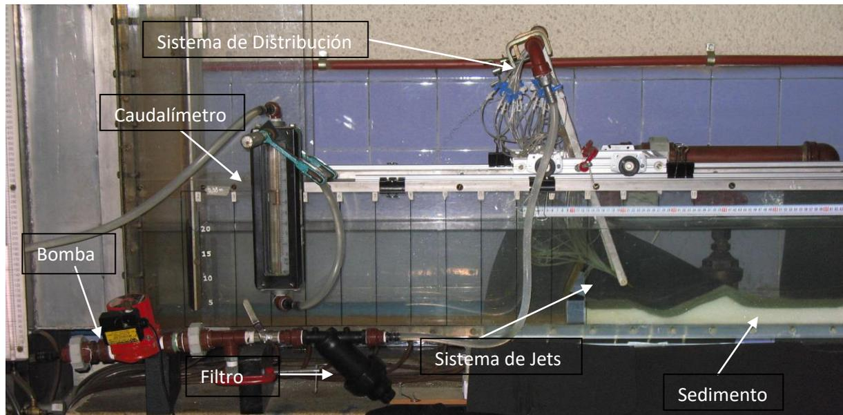
**Figura 5** – Dispositivo Experimental
