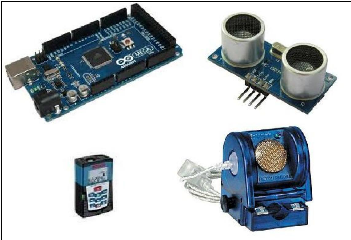
**Figura 1.-** *arr-izq* Arduino Mega. *arr-der* Sensor de ultrasonido HC-SR04. *abj-izq* Medidor de distancias Laser BOSCH DLE70. *abj-der* Medidor de proximidad ultrasónico PASCO PS-2103A.
