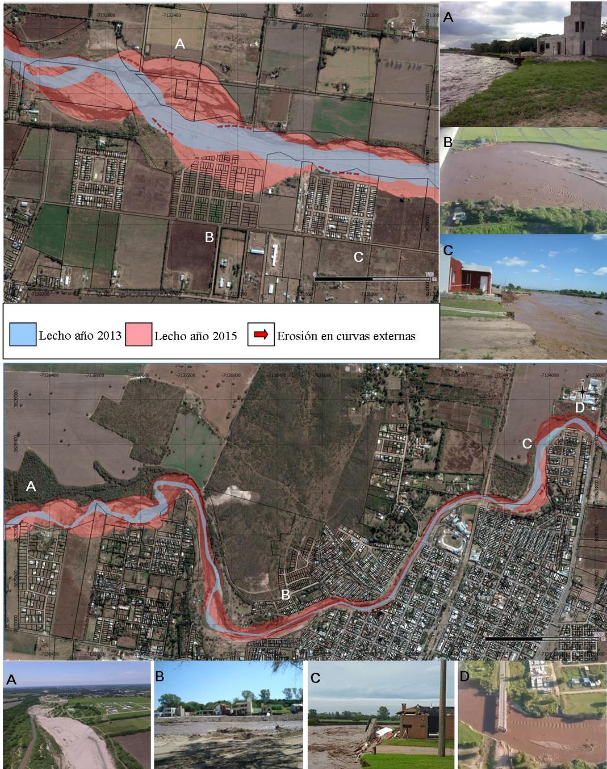
**Figura 7:** Ensanchamiento por erosión lateral del cauce fluvial Río Guanusacate y daños asociados. **Arriba:** Dominio Geomorfológico de la Llanura Oriental. **Abajo:** Dominio de Piedemonte
