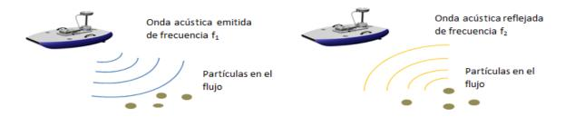
Figura 7.- Esquema de funcionamiento del ADCP
