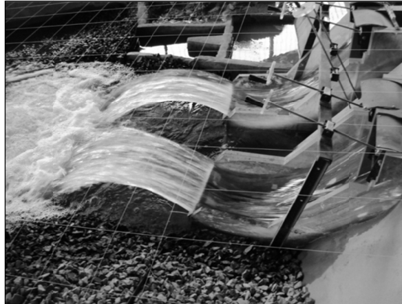
Figura 3.- Funcionamiento de los vertederos
