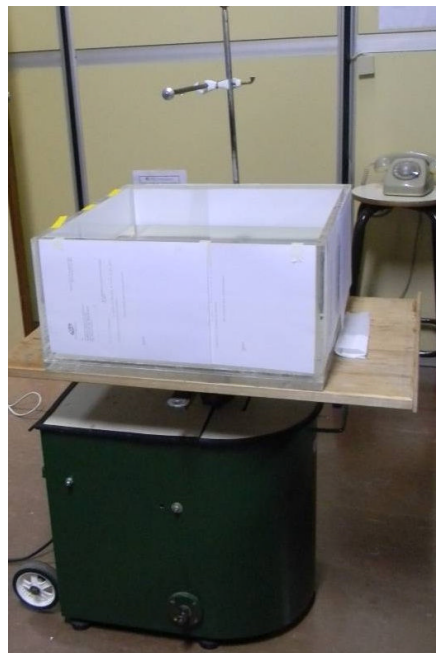
Figura 1. Dispositivo experimental. Los tubos metálicos constituyen los soportes de la cámara de video. Las paredes de la pecera fueron cubiertas con hojas para filmar únicamente el interior de la misma.
