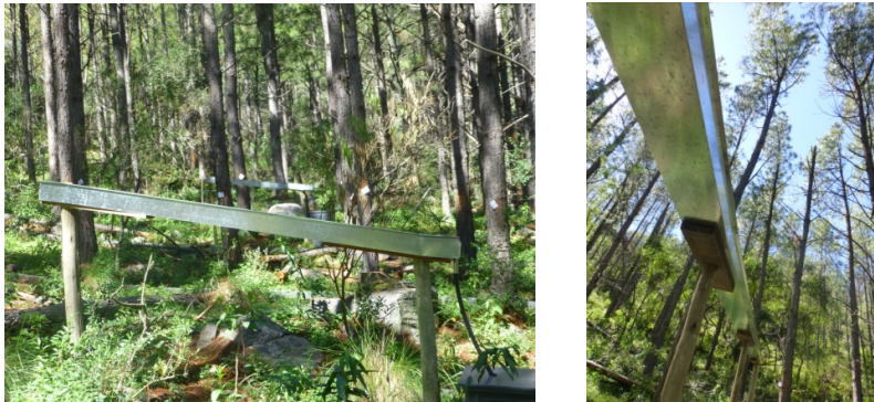
Figura 3- Medición de la Precipitación directa (Pd).
