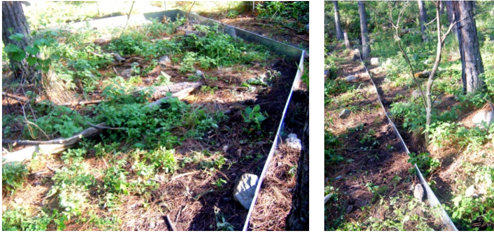
Figura 5.- Parcela de erosión para determinación de tasas de escorrentía, infiltración y erosión.
