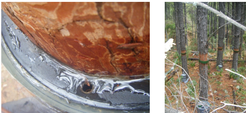
Figura 4- Medición de la Precipitación fustal (Pf).
