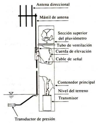
FIGURA 6.5.4 Estación remota que combina medidores de precipitación y de caudal. (Cortesía de Sierra/Misco, Inc. 1986. Utilizada con autorización)
