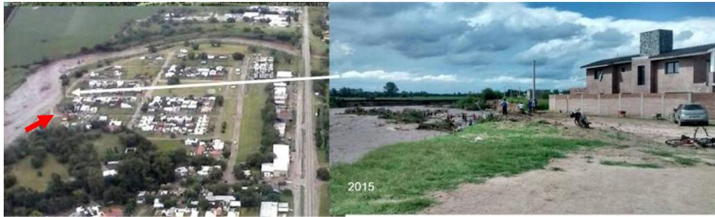
Fig. 16. Migración de curva meándrica y afectación de Bº Agua Mansa (margen derecha).
