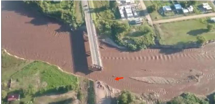
Fig. 18. Migración de curva meándrica y afectación de estribo a margen izquierda. Puente ruta Nac. Nº 9.
