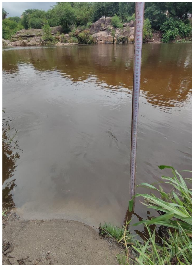
Figura A 11. Aforo de río San Antonio, profundidad de referencia margen izquierda h = 25 cm
