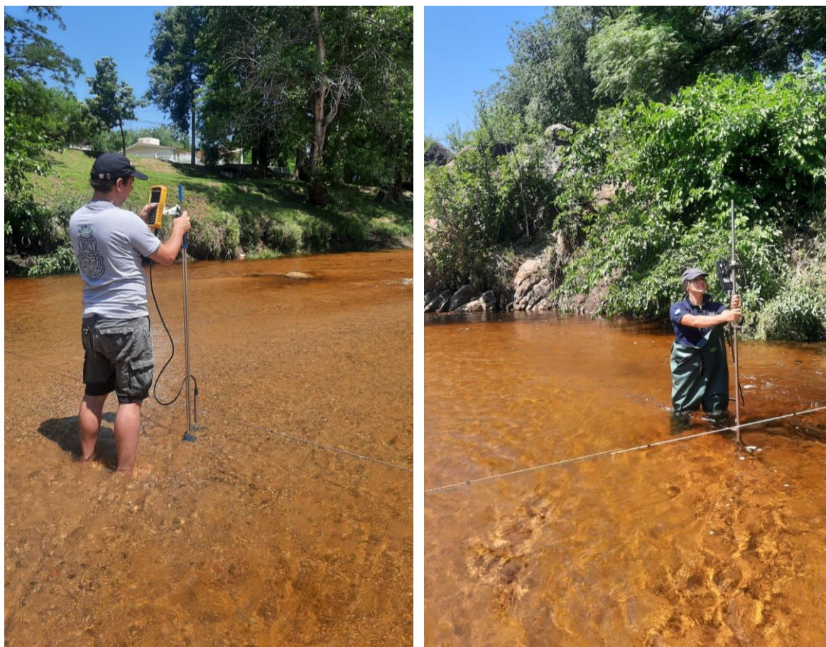
Figura 4.- Aforo de río San Antonio, con FlowTracker2 (izq) y con OTT ADC (der).
