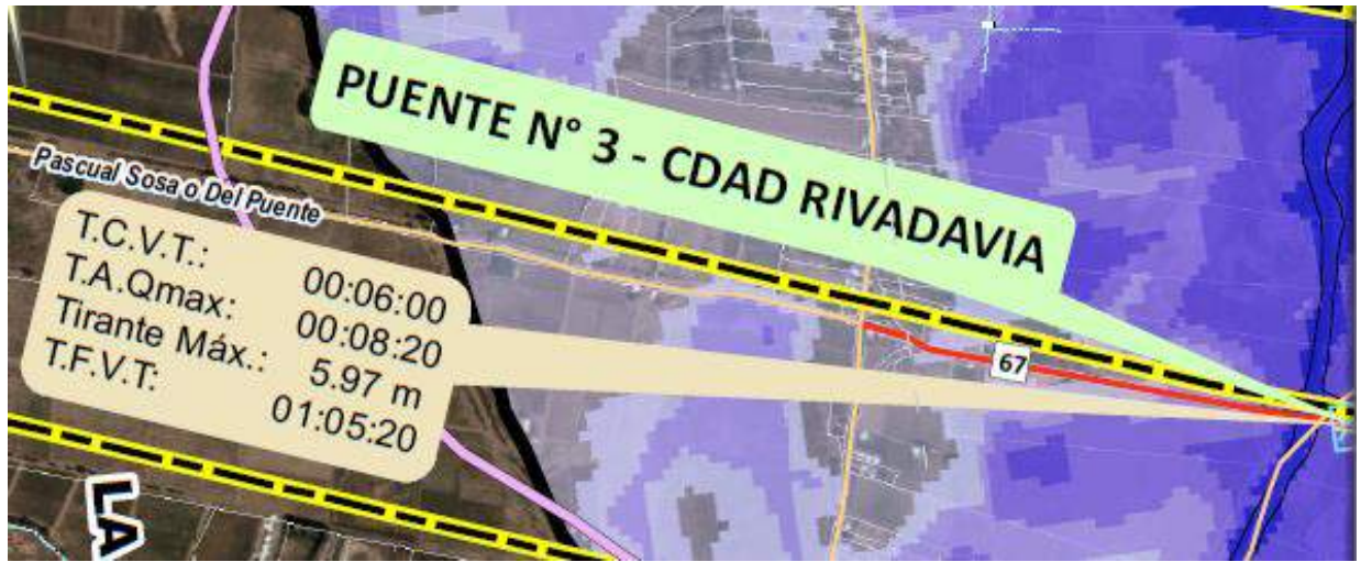
Fig. 9.3 Cartel indicativo de parámetros en las estructuras de cruce de los mapas de inundación
