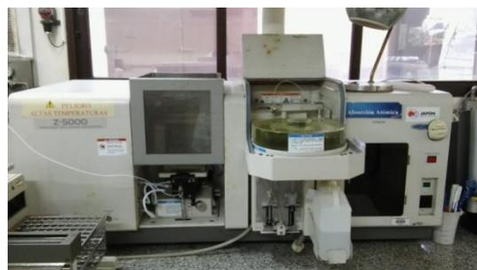
*Figura 14: Espectrofotómetro de Absorción Atómica - Hitachi Z-5000, con llama aire/acetileno*
