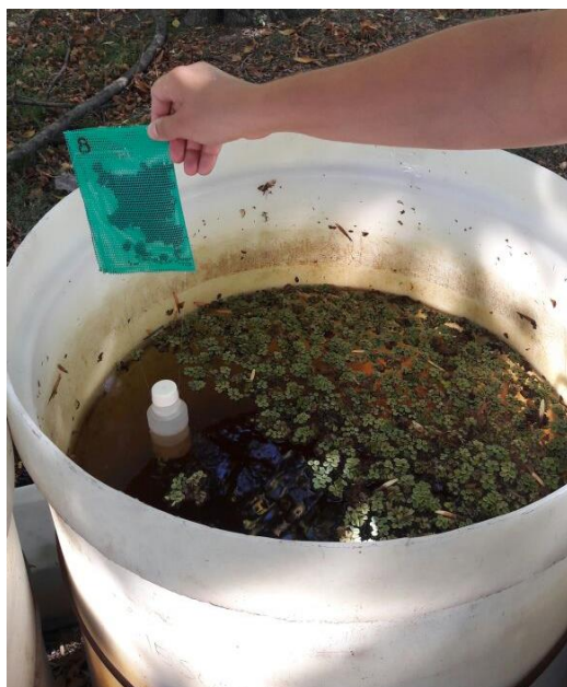
Figura 4.3: Dispositivo utilizado para que las bolsas quedasen sumergidas de forma vertical
