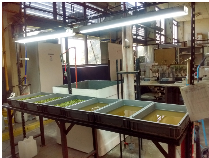
Figura 3.1: Imagen del diseño experimental empleado. Un tratamiento sin plantas y otro con plantas. Ambos por triplicado
