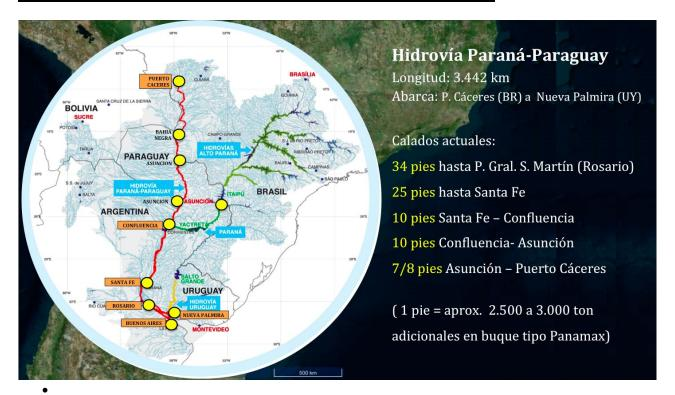
• Buque "de diseño" : PANAMAX: carga 45.000 ton. con 34 pies (por cada 2.200 ton se sumerge 1 pie)
